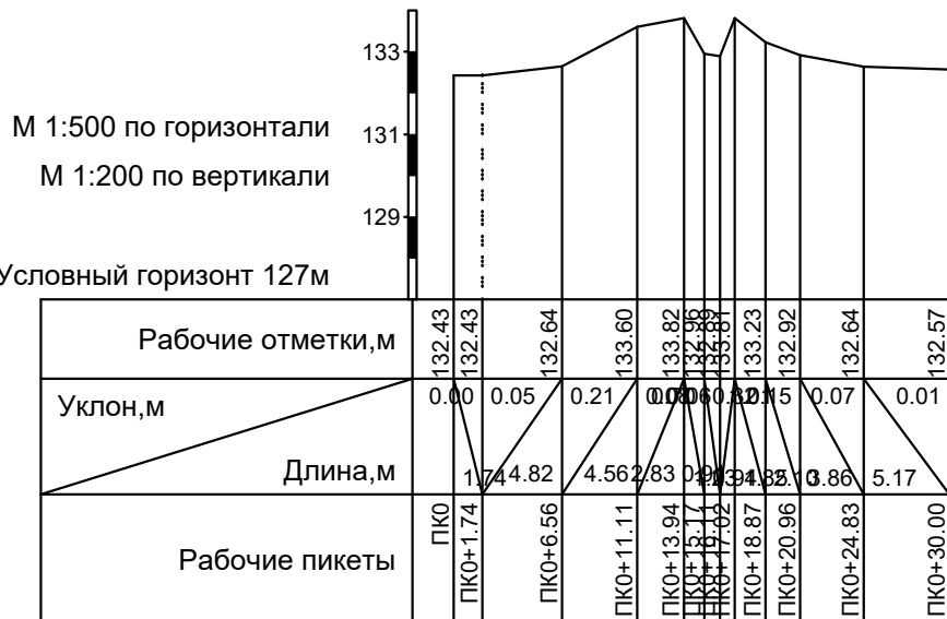
ПОП-11 Продольный профиль от ПК0 до ПК0+30.00
