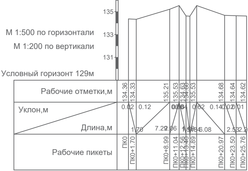
ПОП-7 Продольный профиль от ПК0 до ПК0+25.76
