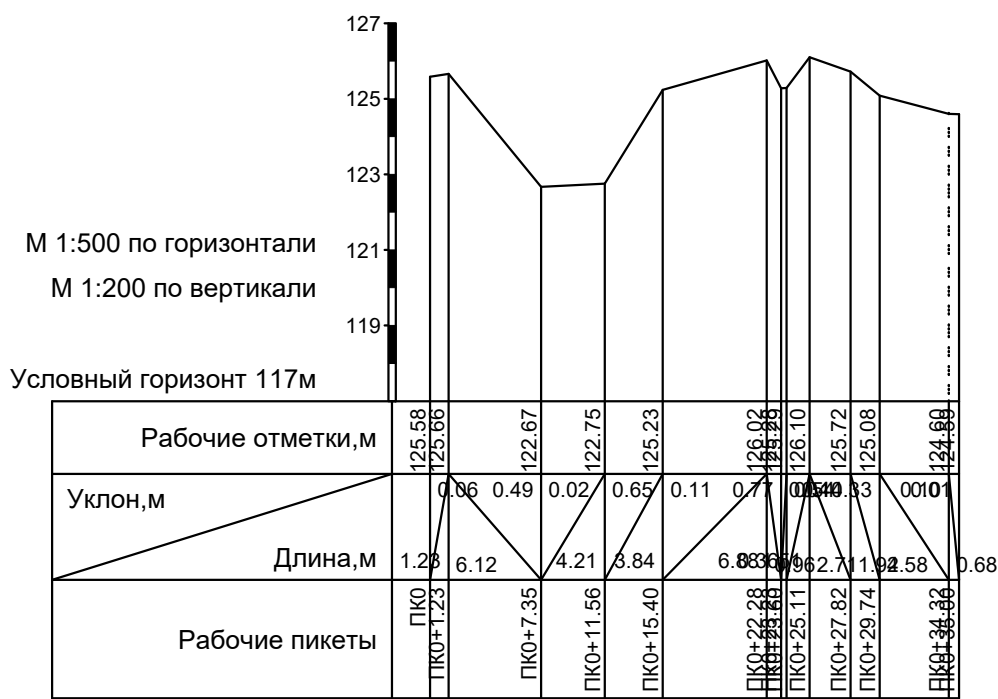
ПОП-3 Продольный профиль от ПК0 до ПК0+35.00
